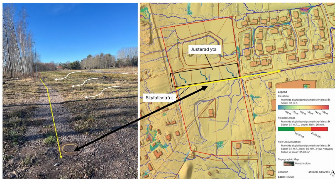
Figur 4: Bild från platsbesök på tilltänkt skyfallstråk som föreslås avvattna tomter i södra delen av norra planområdet. Analysen visar justerad höjdsättning av tomter i söder så att avrinning tydligt styrs mot skyfallstråk (WSP 2026).
